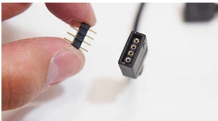
本体側の4ピンRGBコネクタに付属の「変換ピン」を接続します。
