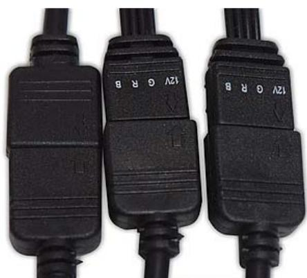
3分岐ケーブル側の4ピンコネクタにRGBファンやLEDストリップなどを接続します。RGB機器とオス・メスが合わない場合は、付属の変換ピンをご使用ください。
