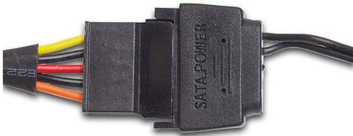
給電はATX電源のS-ATA電源コネクタから
