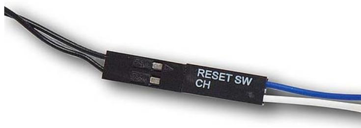
PCケースのリセットスイッチに接続することで、PCケースのリセットスイッチから制御が可能です。※コネクタ同士の▲印を合わせて接続します。
