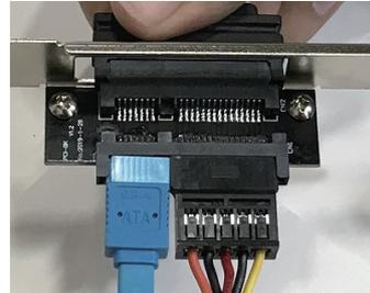
③本製品の基板側に「S-ATA データケーブル」と「S-ATA 電源ケーブル」を接続します。マザーボード側の S-ATA ポートに「S-ATA データケーブル」を接続します。
