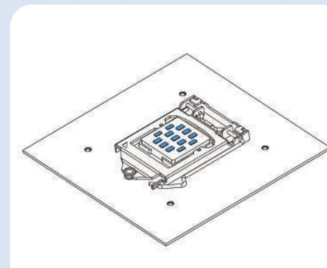
4.マスキングフレームを取外し、CPU COOLERをCPUに取付ます
