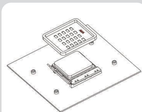
1.AM4マスキングフレームをCPUに載せます
