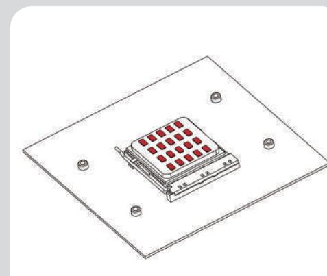
4.マスキングフレームを取外し、CPU COOLERをCPUに取付ます
