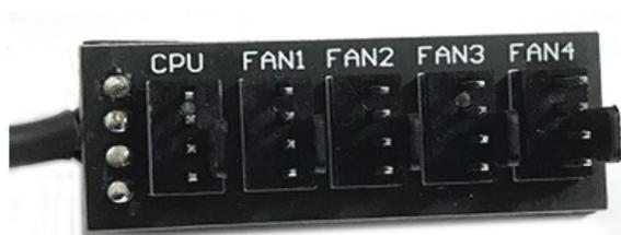
②PCB上には CPU / FAN1 / FAN2 / FAN3 / FAN4 と刻印がありますが、4ピンPWMファンであれば、CPUクーラー、ケースファン問わず接続可能です。
