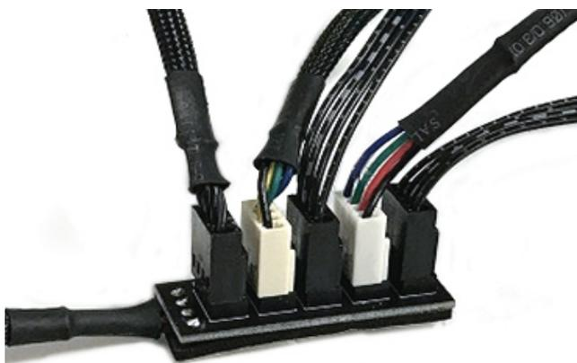
②ファンポートに4ピンPWMファンを接続します。最大4台のファンが接続可能です。マザーボード側のPWM信号に従い接続したファンの回転数が、それぞれ自動可変します。
