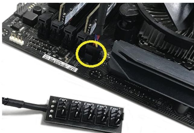
①本製品 (1-TO-4 PWM FAN HUB)をファンコネクタをマザーボードの4ピンPWMファンヘッダに接続します。
