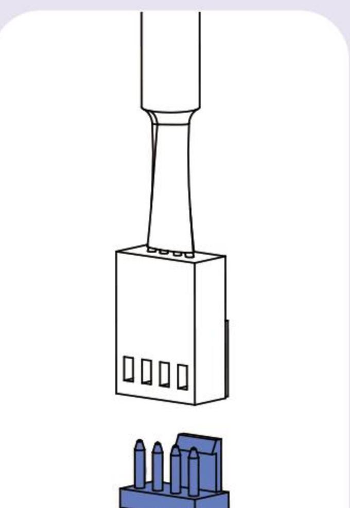
7.ファンコネクターをマザーボードのCPU用FANヘッダに接続します
