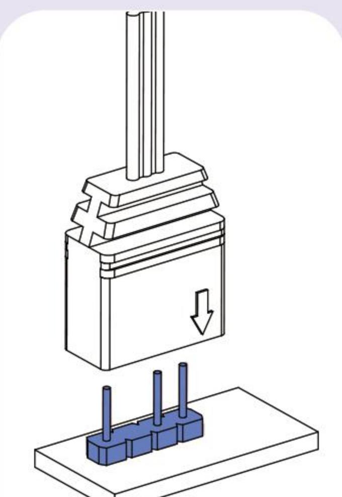
8.FANのARGB端子をマザーボードのARGB端子口へ差し込む
